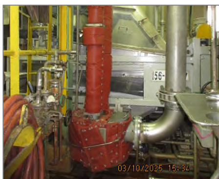
ภาพถ่ายที่ 2.2.1-28 อุปกรณ์ครอบเครื่องจักรที่มีเสียงดัง
