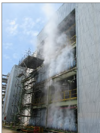
ภาพถ่ายที่ 2.2.1-56 การทดสอบม่านน้ำยา Steam-Ammonia
