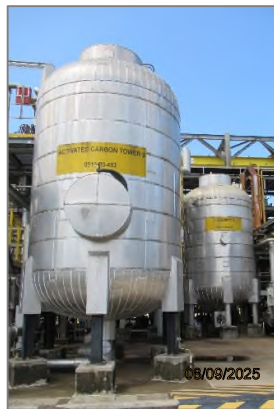
ภาพถ่ายที่ 2.2.1-8 หอถ่านกัมมันต์สำหรับดูดซับซัลเฟอร์
