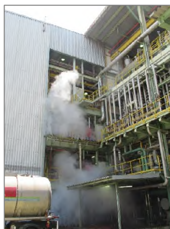
ภาพถ่ายที่ 2.2.1-56 การทดสอบม่านน้ำยา Steam-Ammonia
