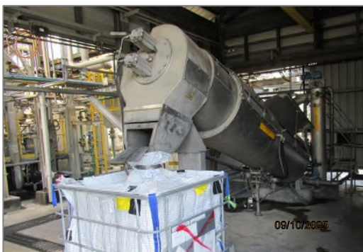
ภาพถ่ายที่ 2.2.1-20 เครื่องรีดตะกอน (Sludge Press)
